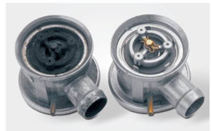
Geöffnetes Sekundärluftventil links: Schäden durch Abgaskondensat rechts: Neuzustand
