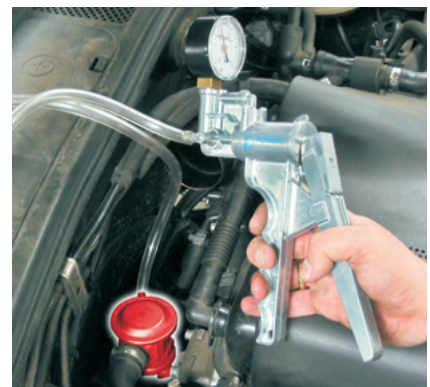
Prüfen eines Sekundärluftventils mit einer Unterdruckhandpumpe
