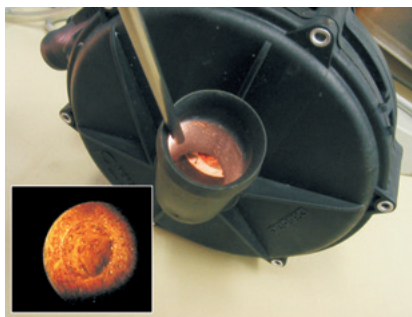
Blick in den korrodierten Einlauf einer Sekundärluftpumpe
